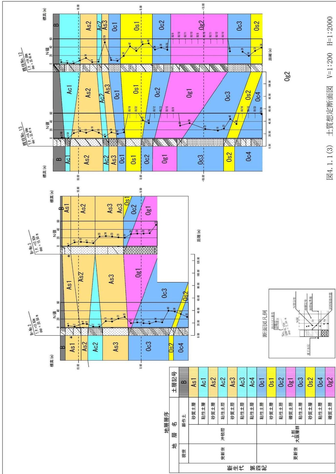
図4.1.1(3) 土質想定断面図 V=1:200 H=1:2000
